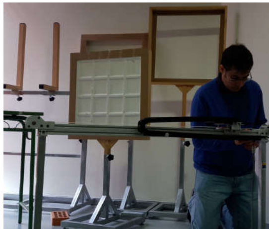
Figura 22 Bases cuadradas para colocación de materiales.
